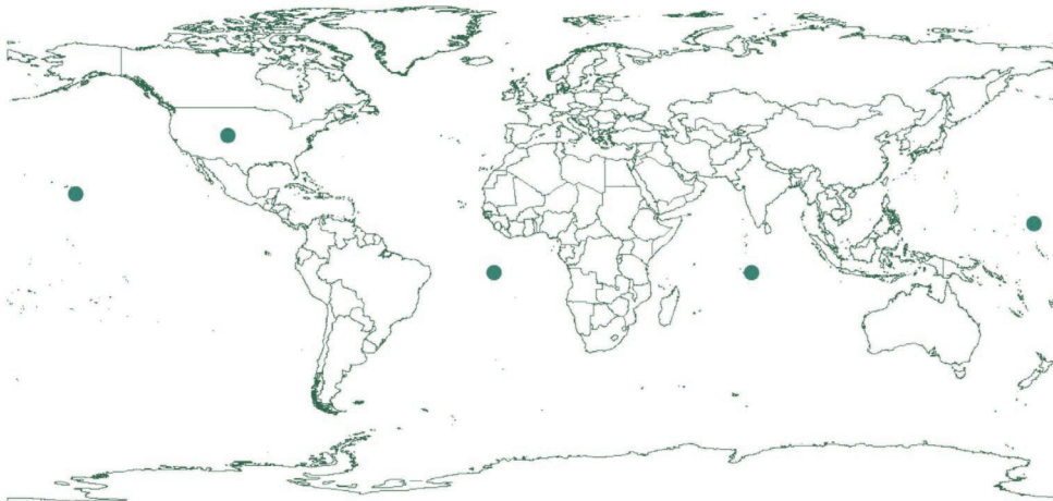
Figura 5.25 - Distribuição das estações do segmento de controle GPS
