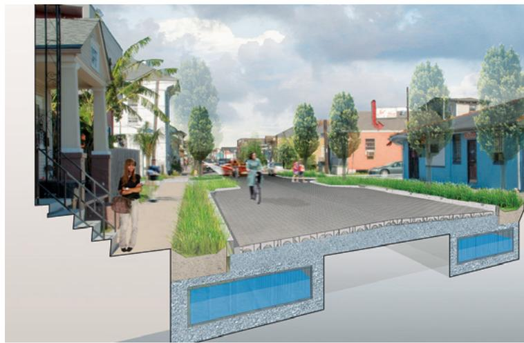
Esta ilustración del Plan Hídrico Urbano de Greater Nueva Orleans muestra cómo el rediseño de calles con elementos como jardines pluviales y pavimento permeable puede ayudar a frenar y almacenar el agua pluvial. Crédito: Waggonner & Ball.
